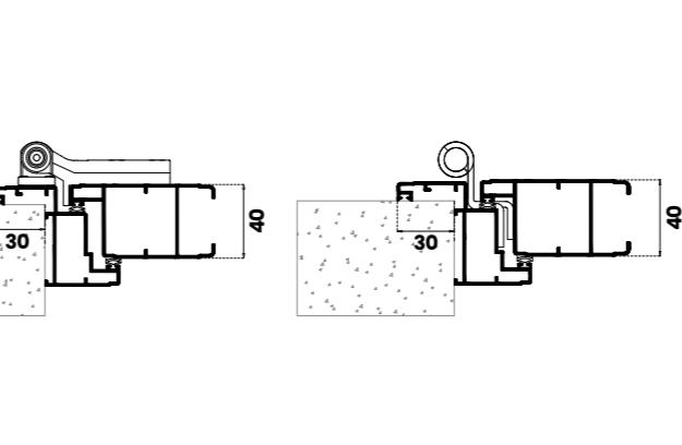
Aurora grilja sa zaobljenim "Z" okvirom ugraduje se na rub fasade. Dužina batude iznosi 30 mm. Na takvu grilju moguće je ugraditi nadgradne okove tipa "Maco" ili sakrivene pante.
