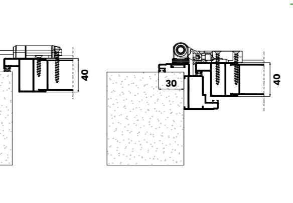
Perun škura omogućuje ugradnju sa okvirom ili bez okvira direktno na kamenu ertu. Ovaj sistem osim klasičnih zaokretnih škura omogućuje izvedbu raznih preklopnih varijanti "alla Padovana" i "alla Vicentina".
